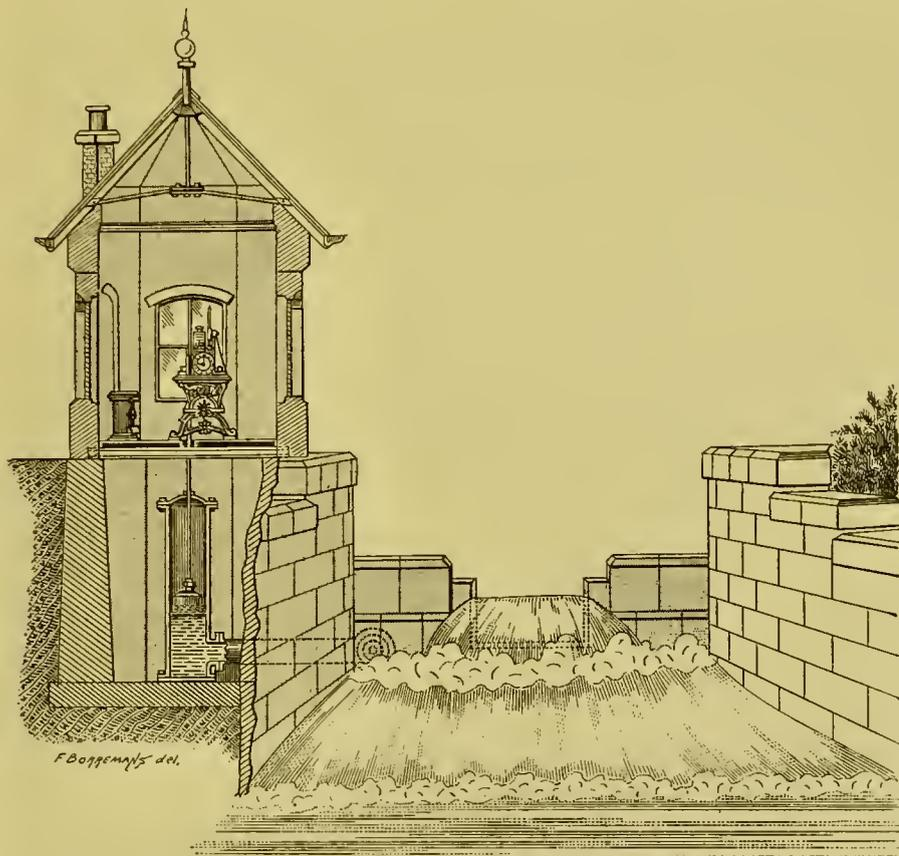
Fig. 7. — Dispositif Clenfield et Kennedy d'enregistrement de niveau.
